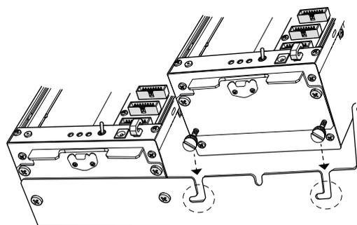
WORKFRAME84 本体をサイドプレートのスリットに対して垂直に降ろした後、手前へスライドさせてから、つまみネジを締めて固定してください。
