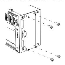
④ ③の手順で取り付けたネジを対角線の順番で 締め付けます。
